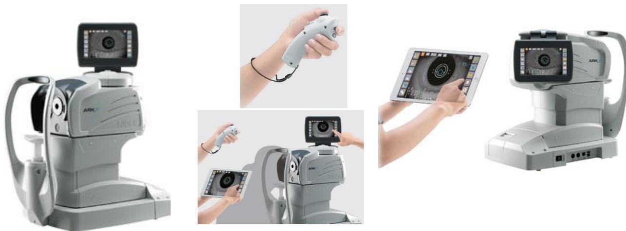
Vollautomatisches Autorefraktometer bzw. Autorefrakto-Keratometer mit Sprachsteuerung, flexibler 7" Touch-Screen-Farbmonitor – neig-, schwenk- und drehbar, kein Joy-Stick, ARK-F – zusätzliche Messung der Sagittal- und Zentralradien, Typ A kann aus der Ferne mittels iPad (über WLAN) angesteuert werden.
