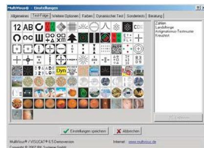
Sehzeichendarbietungssystem mit Alternativ-Polarisationstrennung, Darstellung der Sehzeichen erfolgt auf polarisierten Flachbildschirm, Prüfabstand 4,5 bis 8m mit automatischer Anpassung der Sehzeichengröße, Visus 0,05 bis 2,0 in logarithm. Abstufung, Kontrasteinstellung 5 bis 100%, zufällige oder feste Zeichenfolge bei Zahlen, Buchstaben, Landoltringen, Kinder- Sehzeichen und D6-Test,
